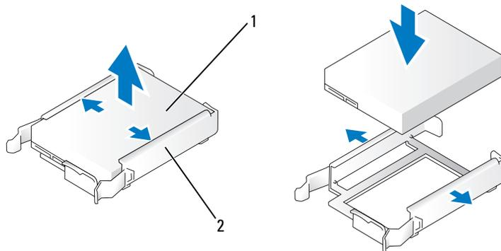
1 硬碟機 2 硬碟機托架
