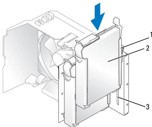
1 硬碟機托架 2 硬碟機 3 硬碟機支架中的導軌
