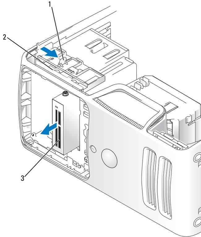
1 磁碟機釋放門鎖      2 滑動板      3 媒體讀卡器
