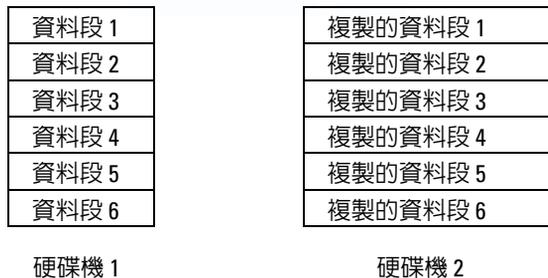
如果一個磁碟機出現故障，系統會將後續讀取和寫入作業引導至仍正常運作的磁碟機。可以使用仍正常運作的磁碟機上的資料重新建立一個替換磁碟機。
