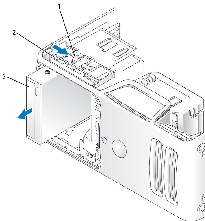
1 磁碟機釋放門鎖      2 滑動板      3 CD/DVD 光碟機
